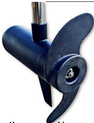
Śruba 2 łopatkowa - wysoki moment obrotowy
